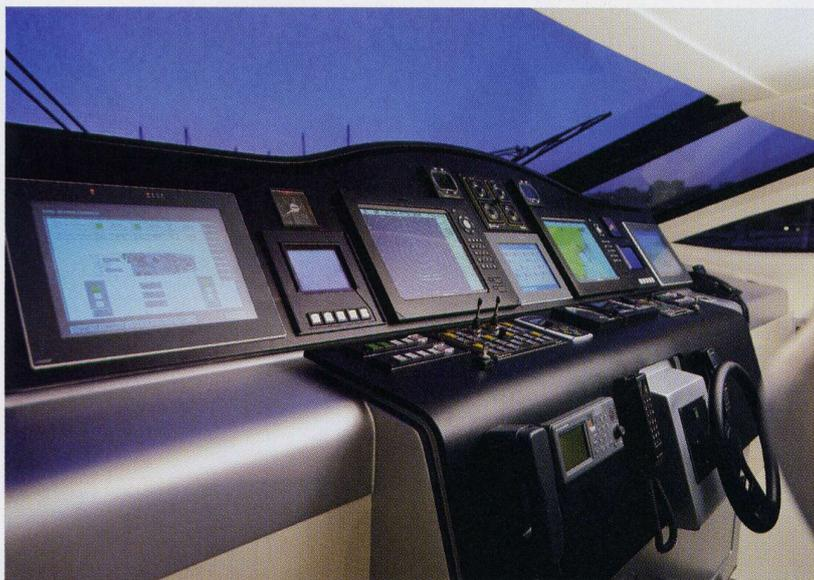
Il posto di pilotaggio è particolarmente completo, con schermi per le diverse funzioni e il controllo, anche attraverso telecamere, di molte funzioni e ambienti. La gestione in manovra degli idrogetti KaMeWa avviene con i comandi a lato delle poltrone.
